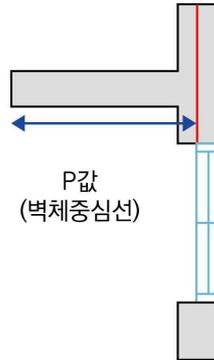
A 에너지절약계획 설계 검토서 주6)에 따른 수평·수직 차양의 돌출길이(P)는 투광부가 설치된 벽체 중심선부터 차양의 끝까지의 길이로 산정합니다.
